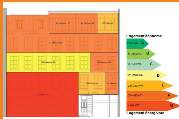
Analyse des consommations énergétiques réelles (chauffage, eau chaude sanitaire et usages domestiques) des logements d'un immeuble en kWh.m².an.
