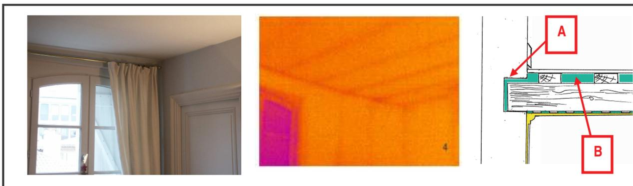
Figure 22 : cas d'un plancher complet : poutres encastrées, enfermées dans un caisson en plâtre (bâtiment 3)
